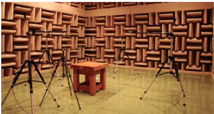
位於大和事業所地下室的音響實驗室。在將回音控制在最小程度的環境下，進行噪音等級的實驗。
